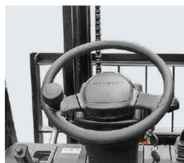
El diseño del volante de pequeño diámetro, junto con el sistema de inversión electrohidráulica y el interruptor combinado de doble palanca tipo automotriz, mejora notablemente la comodidad de conducción.
