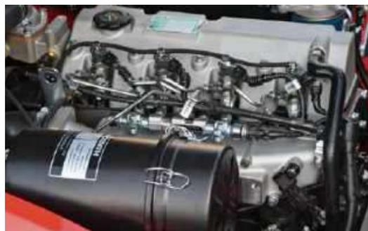
El motor electrónico de riel común de alta presión utiliza tecnología de inyección múltiple a alta presión para garantizar una potente salida de fuerza, menores emisiones y un mejor arranque en frío; además, permite un ahorro del 10 % en el consumo de energía.
