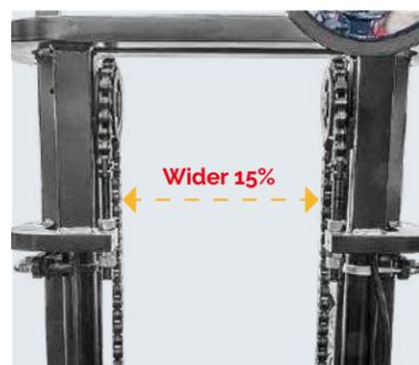
Se adopta un nuevo tipo de perfil estructural tipo caja. Se incrementa el ancho interno del mástil interior y el espacio entre los cilindros de elevación. La reducción en la altura de los instrumentos dentro de la cabina mejora significativamente la visibilidad hacia adelante. La visibilidad trasera también se optimiza gracias al diseño mejorado del contrapeso.
