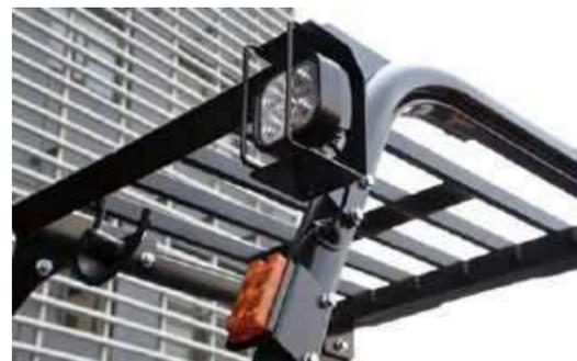
Todo el autoelevador incorpora luces LED como fuente principal de iluminación y un nuevo tipo de retrorreflector panorámico, lo que garantiza el ahorro de energía y potencia, además de mejorar notablemente el rendimiento y la vida útil de las luminarias.
