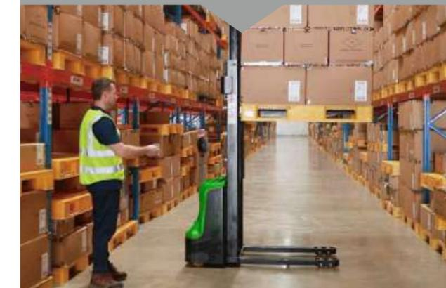
Con el dispositivo de control remoto, puede ajustar fácilmente la velocidad adecuada para el trabajo, desde el nivel 1 hasta el nivel 5. Estas transiciones de velocidad permiten mover el apilador con un manejo controlado y seguro, de manera cómoda.
